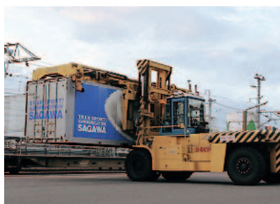
コンテナの積み下ろしをするトップリフター
